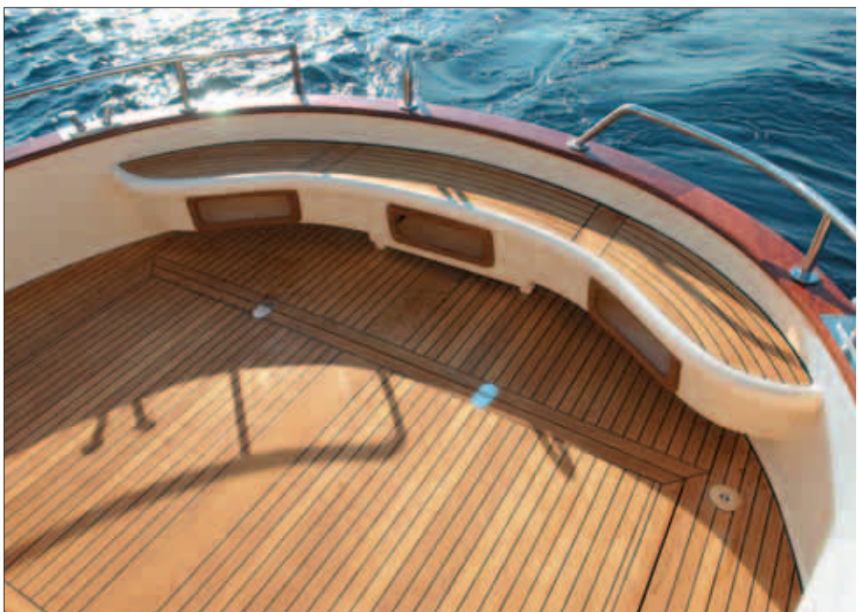
Le teck qui recouvre une cale moteur a deux principales qualités : esthétique et phonique.
